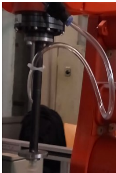
Fig. 6. Efecter vacuumatic cu două ventuze
