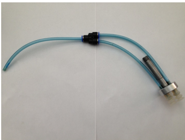
Fig. 4. Efector vacuumatic cu două ventuze
