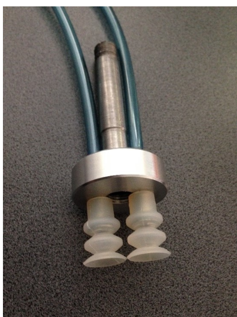
Fig. 5. Detaliu efecter vacuumatic cu două ventuze
