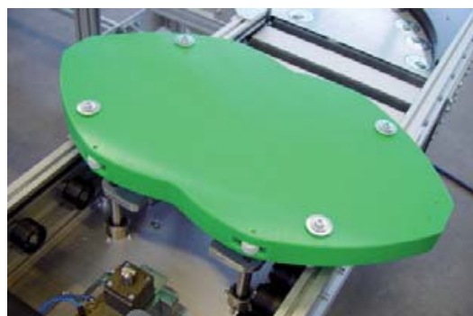
Fig.10. Sistemul de liftare și rotire al paletela la 90°
