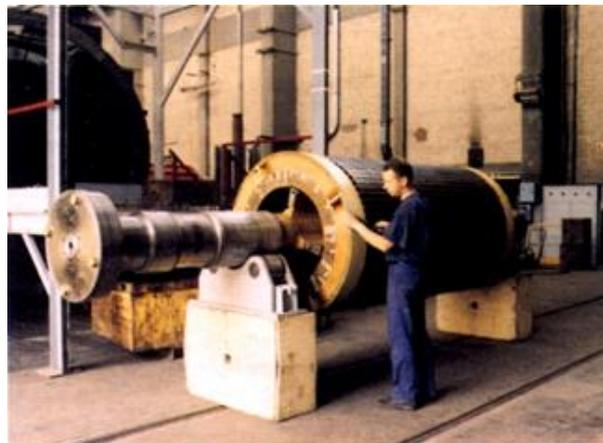
Fig. 3 – Rotor d'alternateur à 4 pôles (1 500 tr/min)
