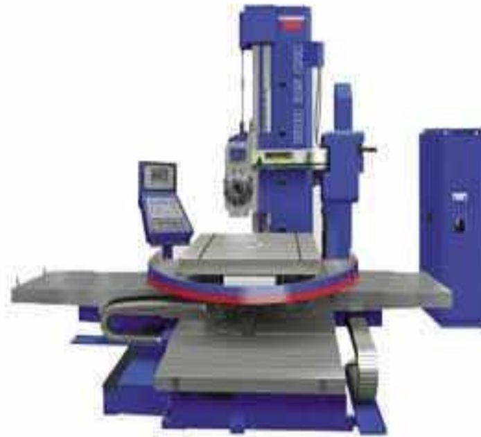
Figura 0.1 - Mașină de alezat și frezat cu comandă numerică [6]
